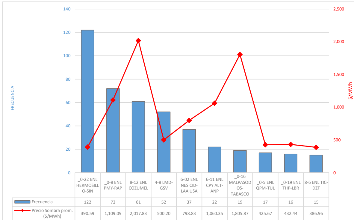
Figura 9a. Frecuencia de Enlaces de Transmisión Congestionados en el MDA.
